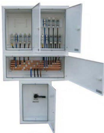
Quadro Coluna 2 Saídas Trif. 250 Amp. s/ Barramento Classe II (Cx. Visbox) CÓDIGO: VB.655
